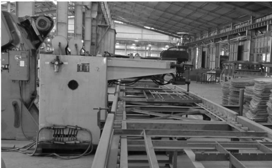
图 2.3-1 单头点焊机装置
